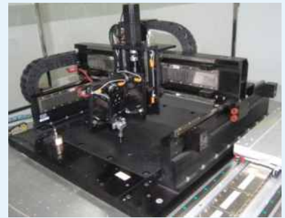
超精密控制系统： 微纳米级别的位置控制
