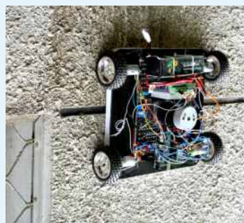
攀爬机器人： 可工作在极粗糙墙面上
