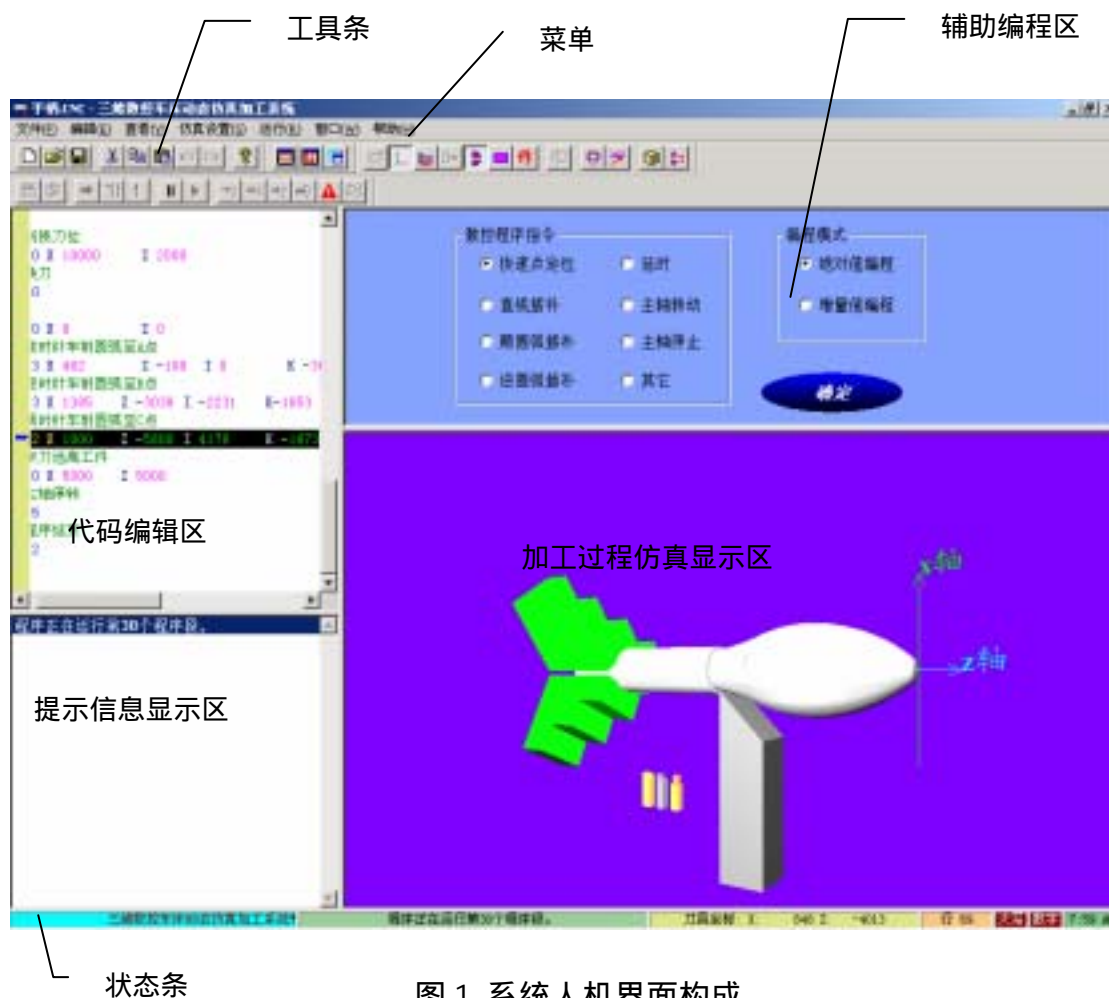
图 1 系统人机界面构成
