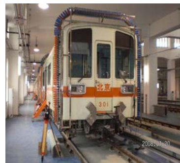
北京市地铁十号线限界检测
