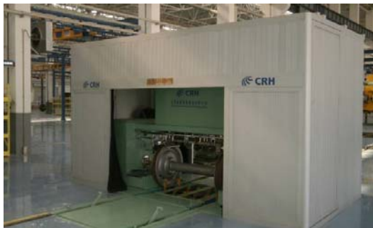
动车组转向架测力构架标定试验台
