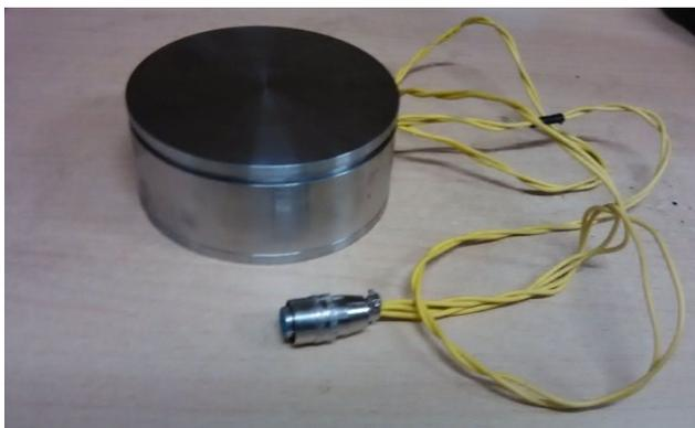
图 1.1 土压力传感器实物图
