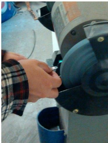
图 1 磨制模型弹性梁（许振东）
