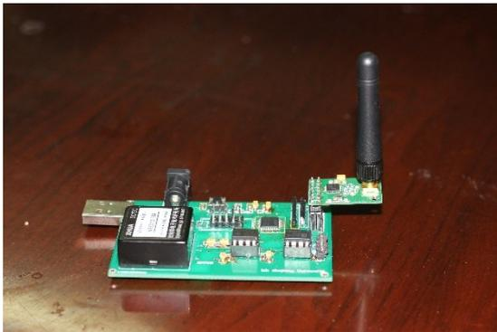
图 2.25 数据采集发送模块实物图
