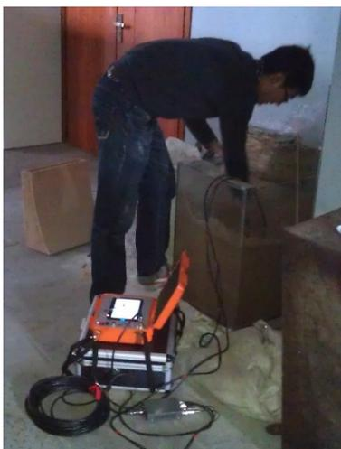
图 3 埋置土压力传感器（梁洪超）
