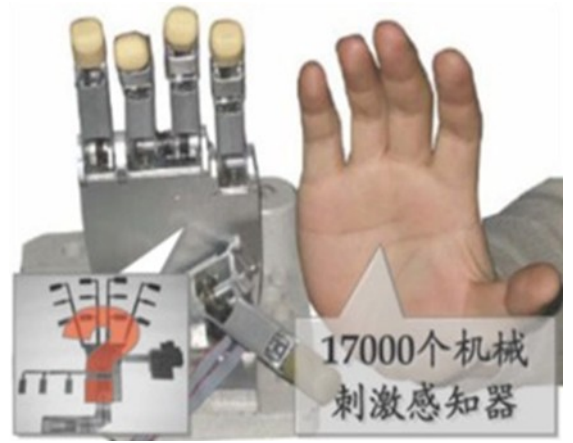
人工触觉系统：集成了上万个磁刺激传感器 聚焦度达到了毫米级
