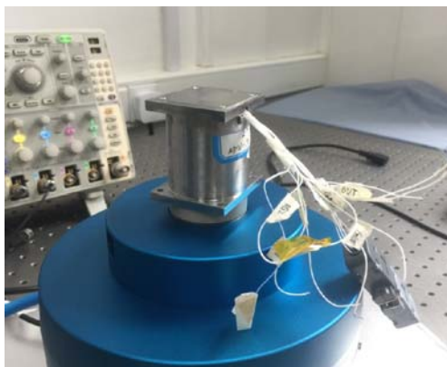
图 6 兰州空间物理技术研究所研制的微角振动传感器测试
